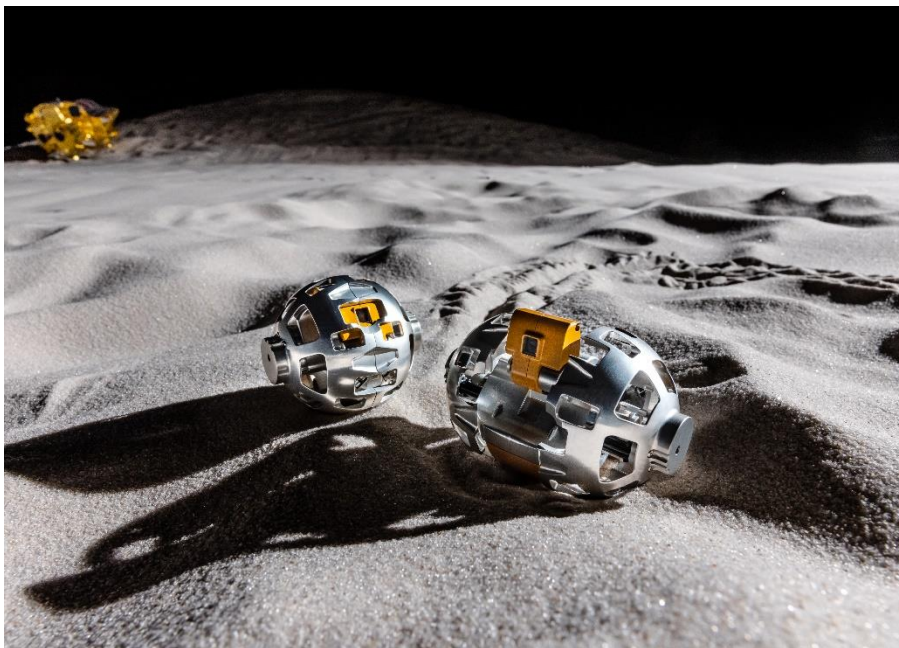
変形型月面ロボット「SORA-Q」(左)変形前 (右)変形後
