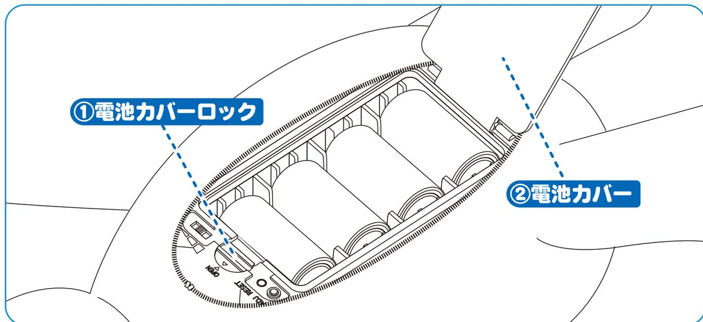
● 乾電池を交換する際は、今セットされている乾電池4本すべてを交換してください。
