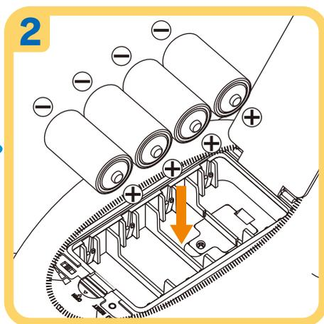
セットされている乾電池を取り外し、新しい乾電池4本と交換してください。
