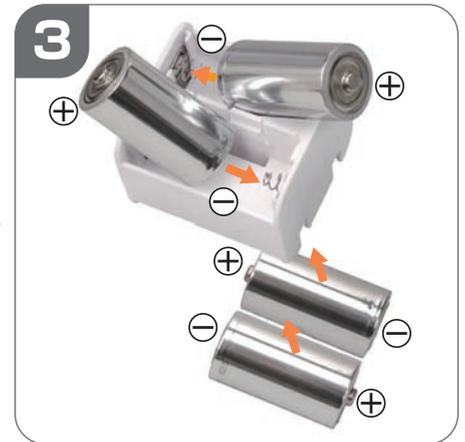
③電池ケースにセットされている乾電池を取り外し、新しい単2アルカリ乾電池4本と交換してください。
