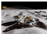
・・・タカラトミーが JAXA、ソニーグループ株式会社、同志社大学と共同開発した超小型の変形型月面ロボットの愛称。玩具作りにおいて培われた小型化、軽量化の知見と、「トランスフォーマー」に代表される変形機構に関わる技術が活用されています。2023年8月以降、「SORA-Q」は JAXA の小型月着陸実証機「SLIM」に搭載され、月に向けて打ち上げられる予定です。
