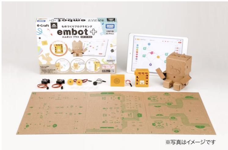
「embot」は、新たな機能を追加し「embot+」として2023年11月15日（水）に発売します。新たにスピーカーを付属し言葉を選んでしゃべらせたり、拡張パーツ（別売）をつなげるなど、より拡張性の高い商品へ進化します。現行品のサーボモーター、LED、ブザーもそのままembot+で利用可能です。
