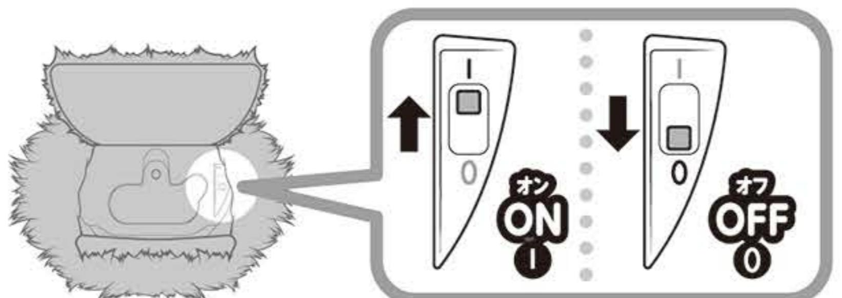
電池ボックスの横に電源スイッチがあります。図を参照しオン(↑)オフ(↓)を切り替えてください。
