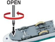
プラスドライバーでシャーシ先端のネジをゆるめ、ボディを取り外してください。
