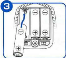
単3乾電池3本を図のように正しい向きに注意してセットします。
