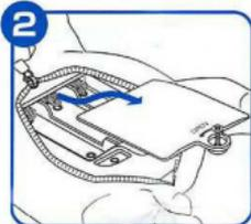
**②電池カバー**のビス留め側を持ち上げながら外します。
