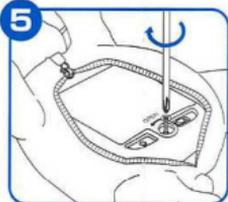
**④電池カバーネジ**を右方向に回して固定します。
