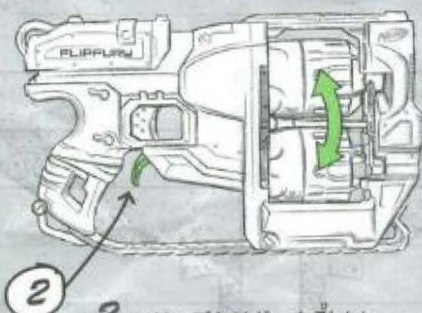
2. フリップトリガーを引くと、上下のローテーティングドラムがチェンジします。
